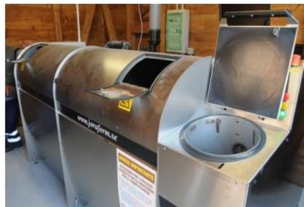
Compostiera (aerobica) di quartiere: può compostare l'umido di 400 persone
